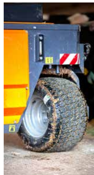
Фото 1, 2. Заднее поворотное колесо позволяет PanMix разворачиваться на одном месте. Компактные размеры машины (длина/ширина/высота: 2 200/1 300/1 350 мм) позволяют удобно маневрировать в узких проходах коровников
