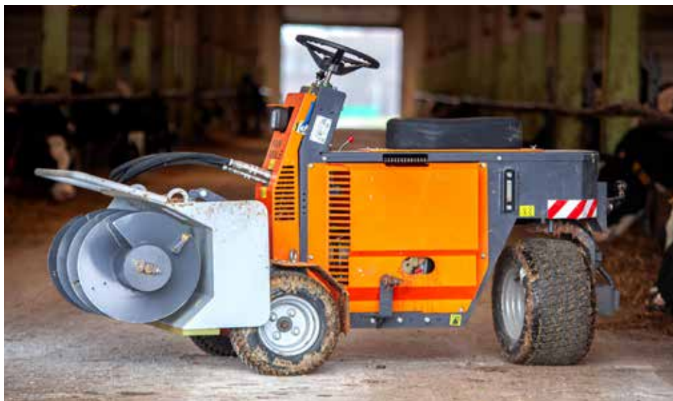
Фото 1, 2. Заднее поворотное колесо позволяет PanMix разворачиваться на одном месте. Компактные размеры машины (длина/ширина/высота: 2 200/1 300/1 350 мм) позволяют удобно маневрировать в узких проходах коровников
