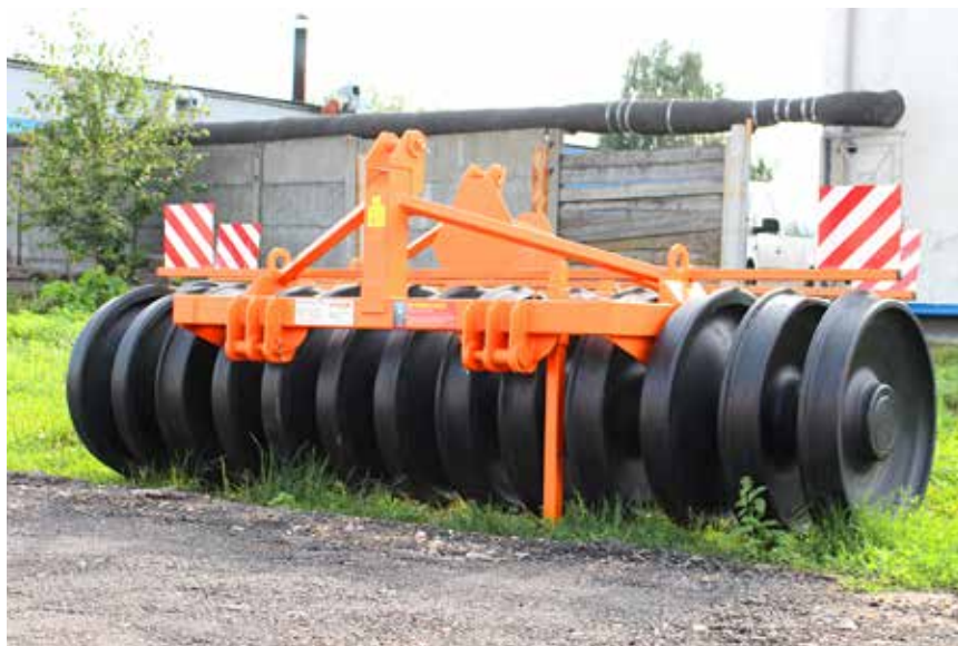
Фото 3. Трамбовщик силосно-сенажной массы
